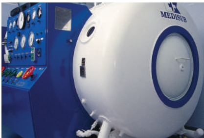
Figura 10. Cámara hiperbárica multiplaza de Medisub; se pueden tratar hasta 7 enfermos simultáneamente. Figure 10. Hyperbaric multi-place Medisub chamber; up to 7 sick patients can be treated at a time.
